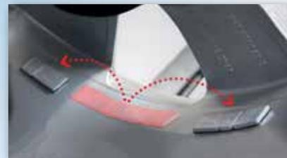
Équilibrage précis avec répartition des masses derrière les bâtons, préservant ainsi l'esthétique de la jante et le visuel extérieur de la roue.
