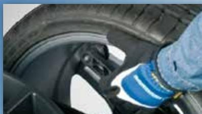
Les techniciens n'ont qu'à positionner le bras de jauge sur la jante pour que le système saisisse automatiquement les dimensions de celle-ci tout en sélectionnant le mode d'équilibrage approprié.
